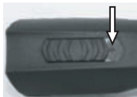
Fig. 4 Interruttore in posizione ferma ("0")
